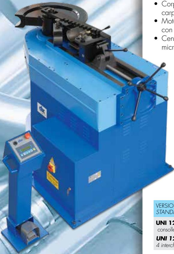
UNI 120, una curvatubi potente e precisa per curvare tubi di grande diametro. I raggi di curvatura ottimali non deformano in alcun modo i tubi curvati: ideale per le varie esigenze degli operatori nei settori dell'idraulica, nautica, oleodinamica, impiantistica in genere.
